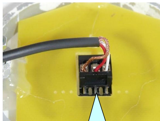
Zapojení násuvné svorky do konektoru antény.
