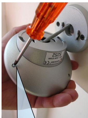
5. sešroubování krabice. Zadní díl je nutno s víkem spojit pomocí dvou šroubů (součástí krabice).
