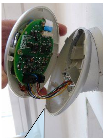
4. spojení víka se zadní částí krabice. Víko do zadního dílu zapadá pomocí naznačených zámků na obou dílech, po spojení je nutno zajistit pootočením víka.
