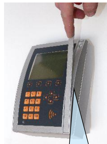
6. vložení krycích lišt
