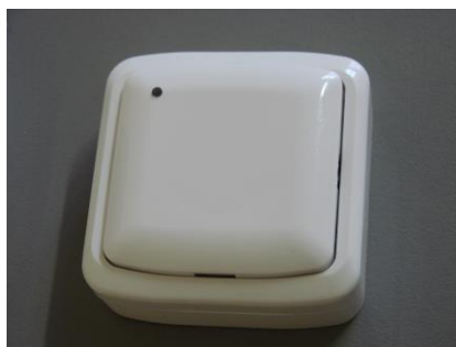
Terminál TR43 v krytu a instalační krabici ABB Tango
