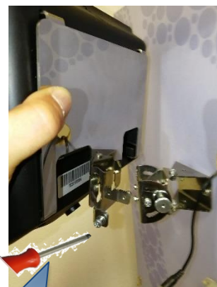
Nasadíme na spodní díl držáku a zajistíme šroubky
