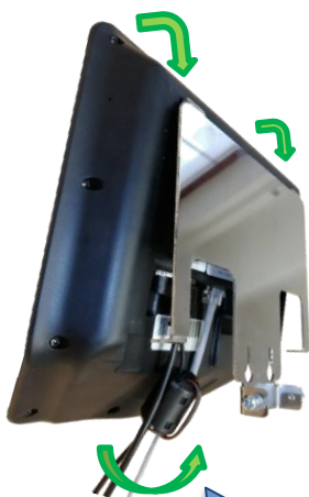
Terminál nasadíme na držák a přikloníme k držáku
